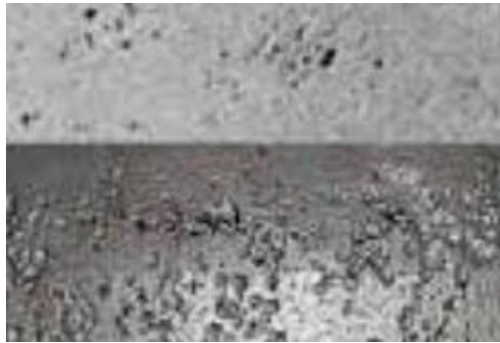
Şekil 1.9. Taneler arası korozyon
