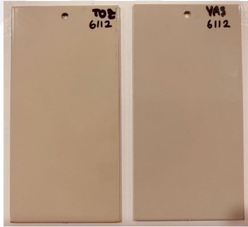
Şekil 2.3. Toz ve akrilik boya sonrası metal numune plakası
