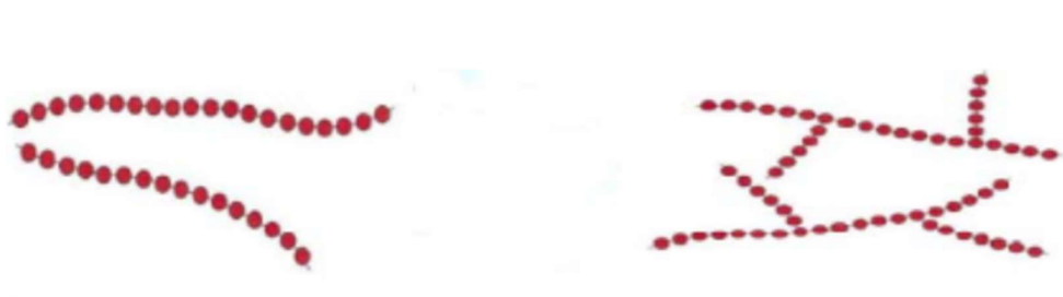
Şekil 1.2. Termoplastiklerin polimer zincir yapıları (Ekşi, 2007)
