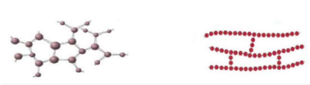
Şekil 1.1. Termosetlerin polimer zincir yapıları (Ekşi, 2007)
