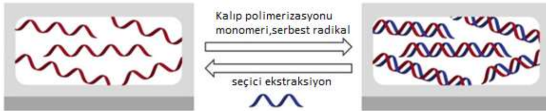
Şekil 2.4. Düzenli nanospace ile ince gözenekli film üzerinde şablon (template) polimerizasyonu (Goseki, 2014)
