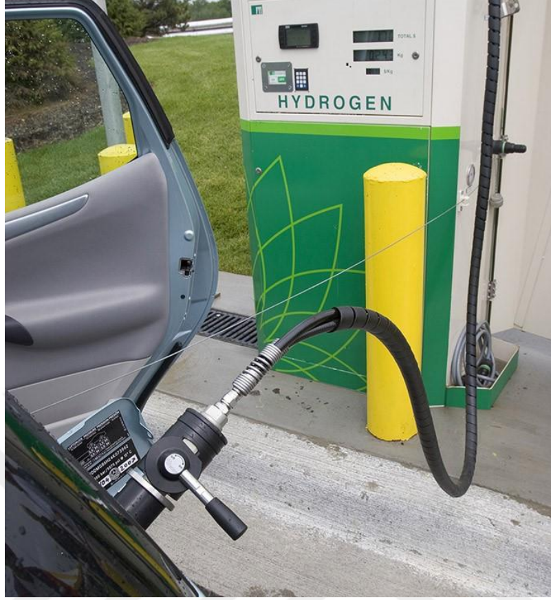
Şekil 1. 11. Hidrojen Yakıt Pili Aracın Şarj İstasyonu
