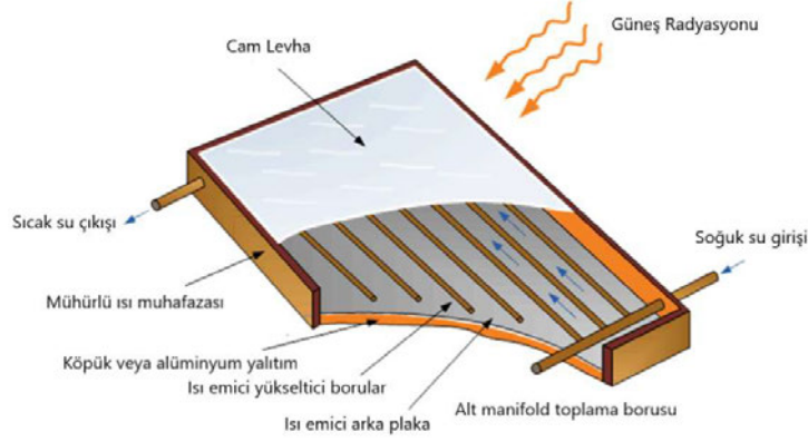
Şekil 2.3. Düzlemsel kollektör çalışma prensibi (Anonim 2015)
