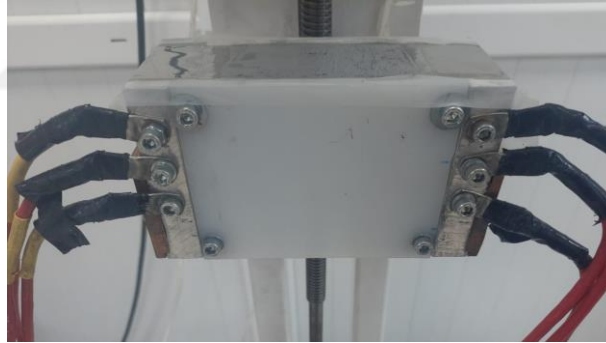
Resim 2.5. DC güç kaynağına elektrik bağlantı elemanları
