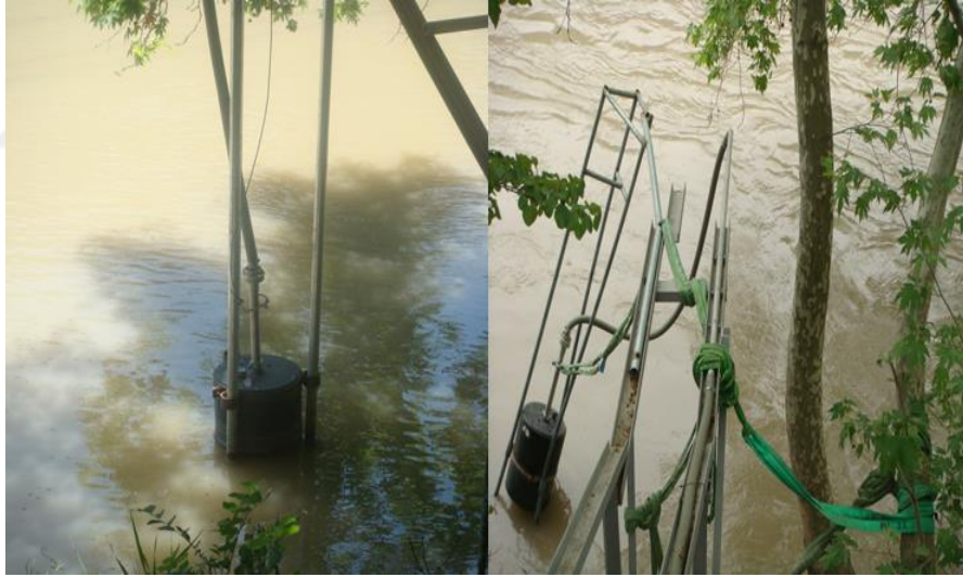
Resim 2.1. Nehir suyunda ani yükselme sonucu şamandıranın bükülmesi
