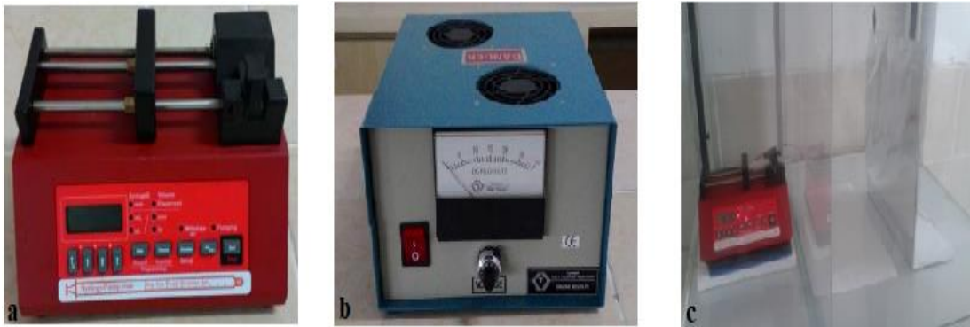
Resim 2.3. Elektrospınleme dzenegđi elemanları a) Şırınga Pompası b) Güç Kaynađı c) Toplayıcı Plaka
