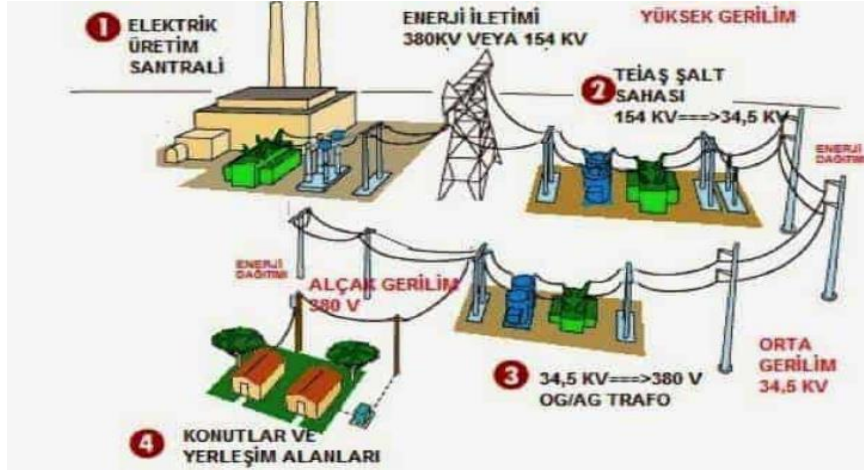
Şekil 2.7. Elektrik enerjisinin üretim, dağıtım ve tüketimi (Özupak, 2020)
