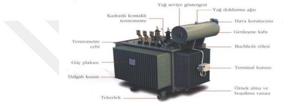
Şekil 2.12. Yağlı tip dağıtım transformatörü ve elemanları (Url-3, 2018)
