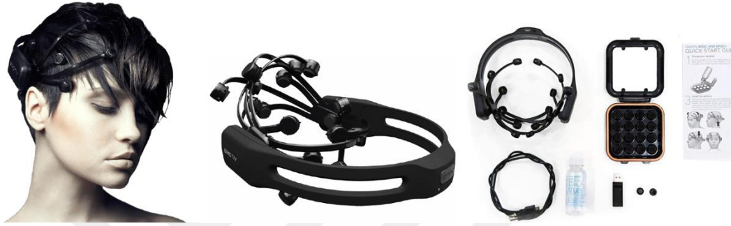
Őekil 4.7. 14 Kanallı Emotiv Epoc Cihazı ve Paraları ( https://www.emotiv.com/files/Emotiv-EPOC-Product-Sheet-2014.pdf )
