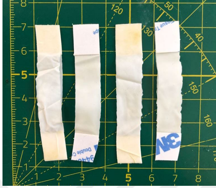
Resim 2.17. Lateks malzeme kullanılarak üretilmiş olan tendon yapısı.
