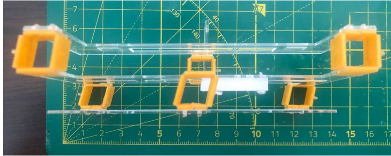
Resim 2.10. Kapton malzeme kullanılarak üretilen dış iskelet yapısı.
