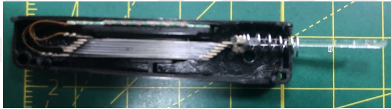
Resim 2.14. Nitinol eyleyicinin iç yapısı ve yay mekanizması modifikasyonu.
