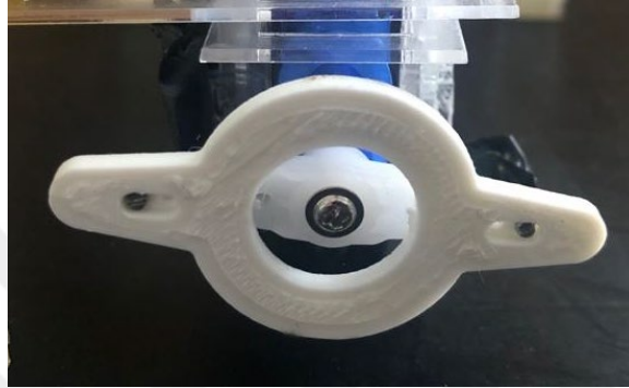
Resim 2.20. Sürekli dönebilen servo motor kullanımı ile oluşturulan dönme mekanizması.
