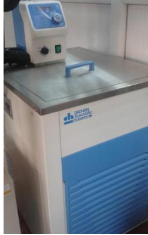
Resim 2.25. Daihan Scientific marka sirkülasyonlu su banyosu
