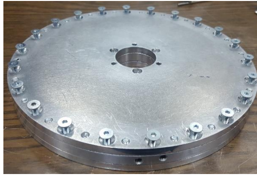
Resim 2.19. Kademeli yan kapakların montaj esnasındaki bir görüntüsü
