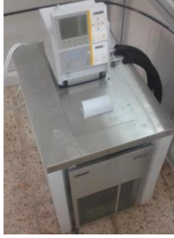
Resim 2.24. Lauda marka aşırı su soğutma devresi dolaşimli su
