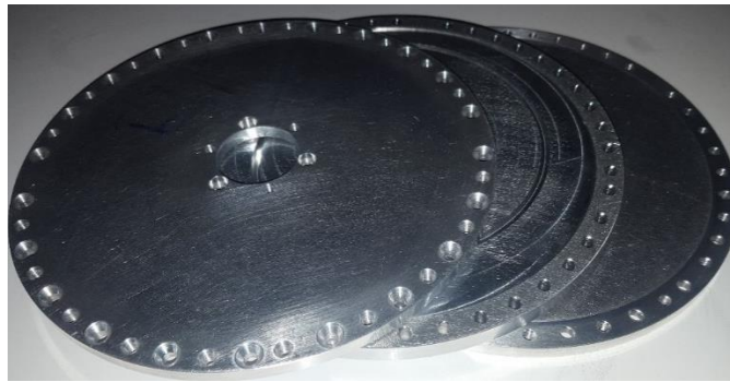
Resim 2.11. Kademeli yan kapakların disk ile birlikte görüntüsü
