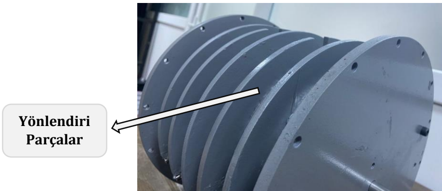
Resim 2.13. Yönlendirici parçalarının montajlanmış görünümü
