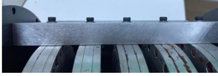
Resim 2.20. Sabitleyicinin SMKD'lerle montajlanmış hali
