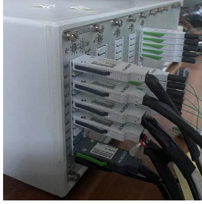
Resim 2.30. Veri toplayıcı ve ölçüm cihazlarının konektörler ile bağlantısı
