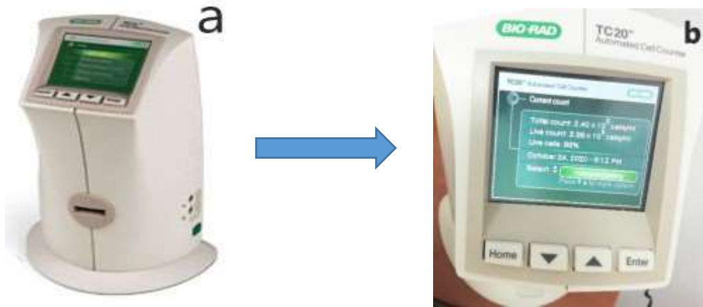
Resim 3.16. a. Hücre sayım cihazı b. Hücre sayım sonuç ekranı
