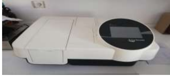
Resim 3.26. UV- Spektrofotometre (Biochrom Libra S50)
