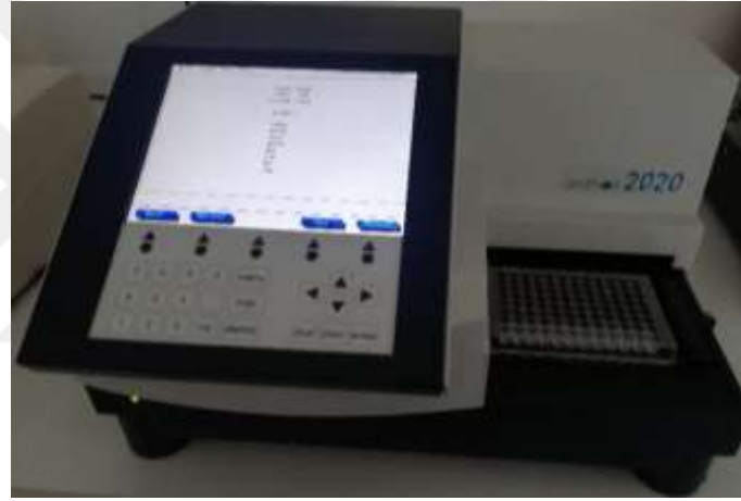
Resim 3.24. Mikroplaka ELİSA okuyucu (Biochrom anthos, 2020)
