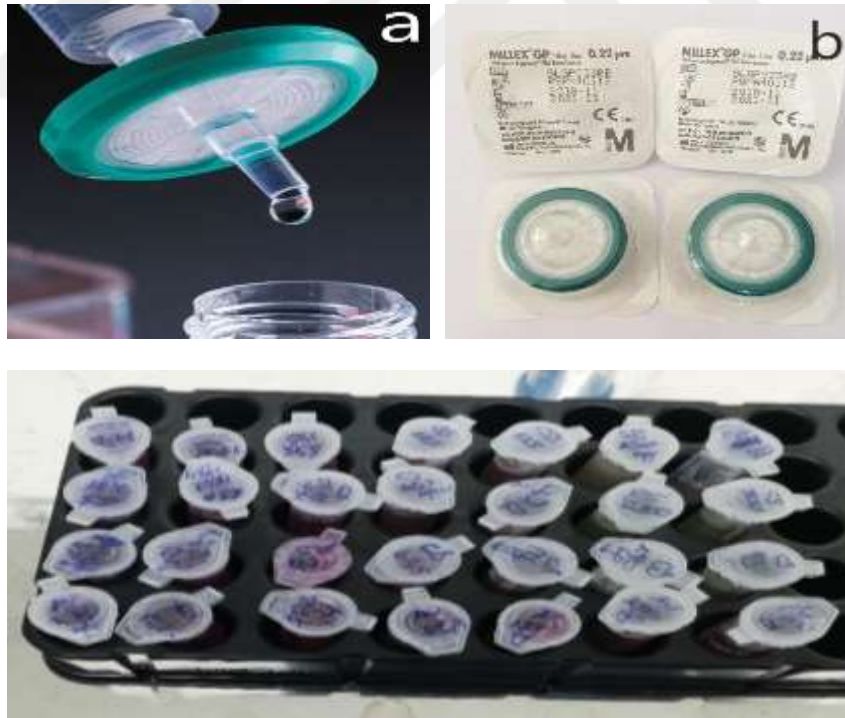
Resim 3.17. a. Materyalin filtrelenmesi b. Kullanılan filtreler c. 1,5 ml'lik steril epondorfa filtrelenmiş materyaller
