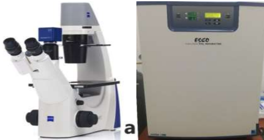
Resim 3.9. a. İverted mikroskop (Zeiss) b. %5 CO 2 ’li etüv (ESCO)
