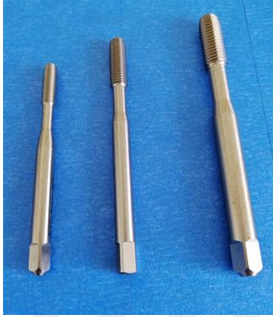
Resim 4.2. Deneyde kullanılan sıvama kılavuzları
