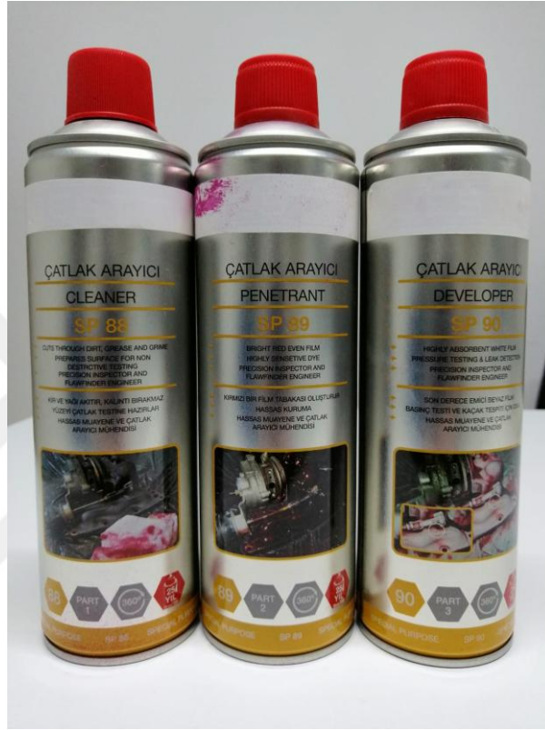
Resim 5.15. Penetrant test sprejleri
