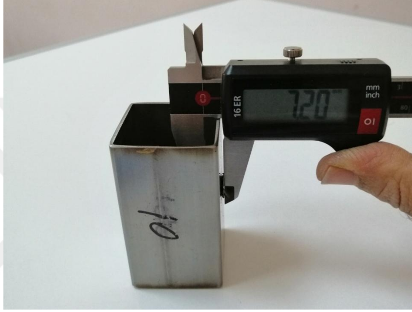
Resim 5.7. Kovan yüksekliği ölçümü
