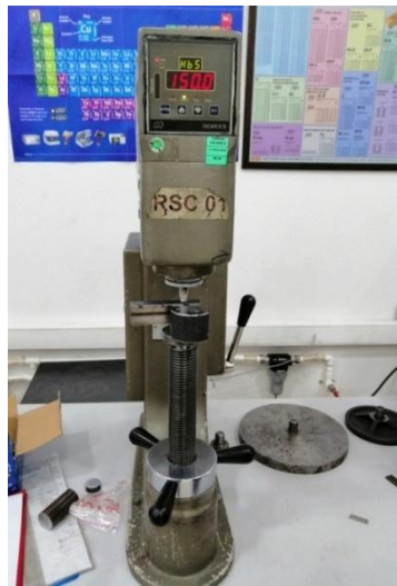
Resim 5.14. Sertlik testi cihazı
