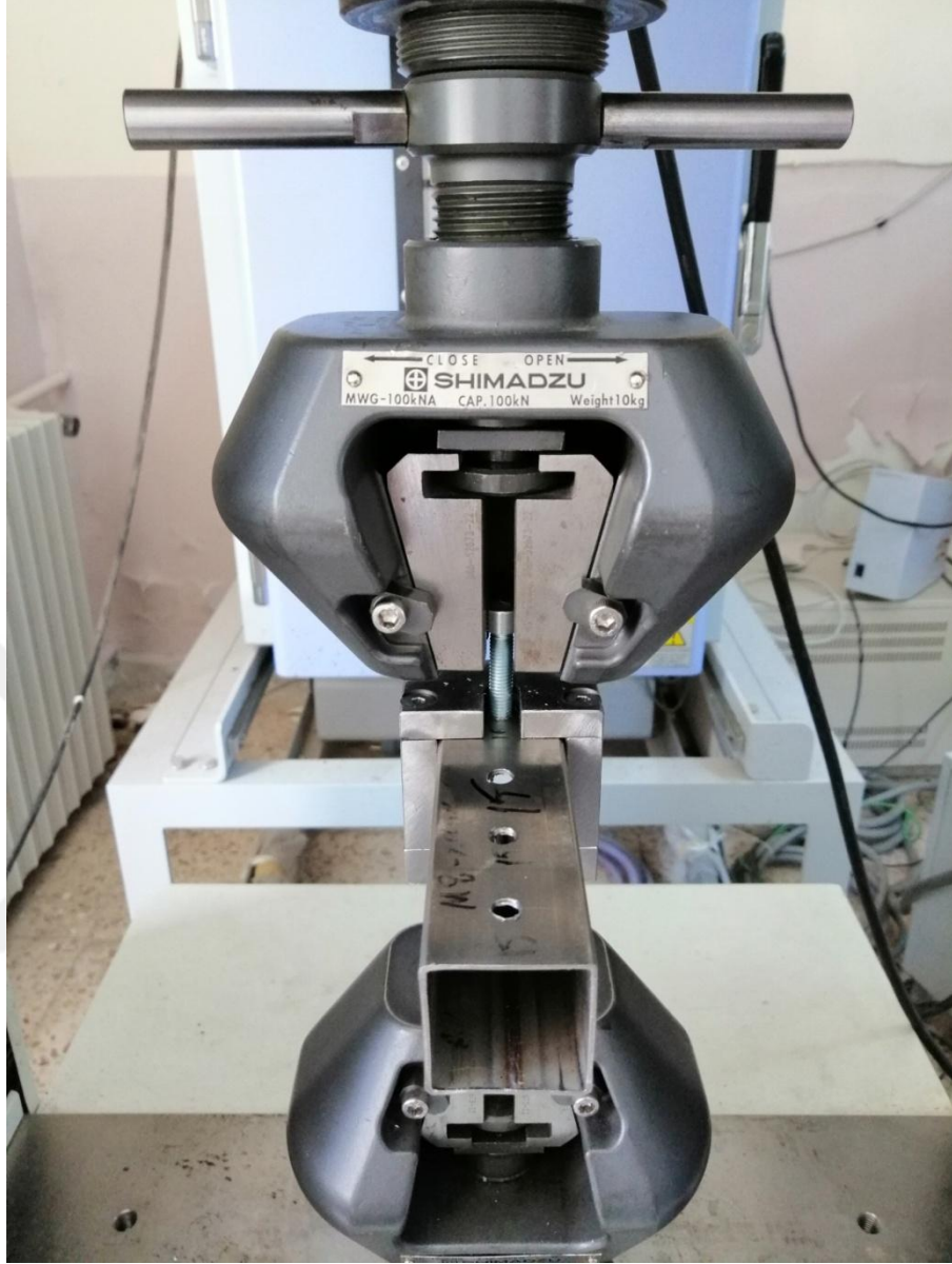
Resim 5.12. Matkap ucu yöntemi ile delinmiş sıyrma testi deneyi
