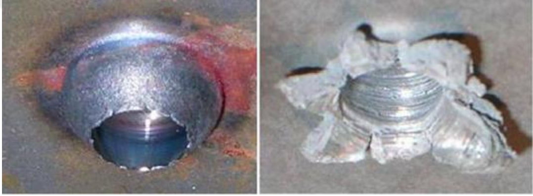
Şekil 3.14. Sıvama ile delik delmede oluşan kovan şekilleri (Doğru, 2010)
