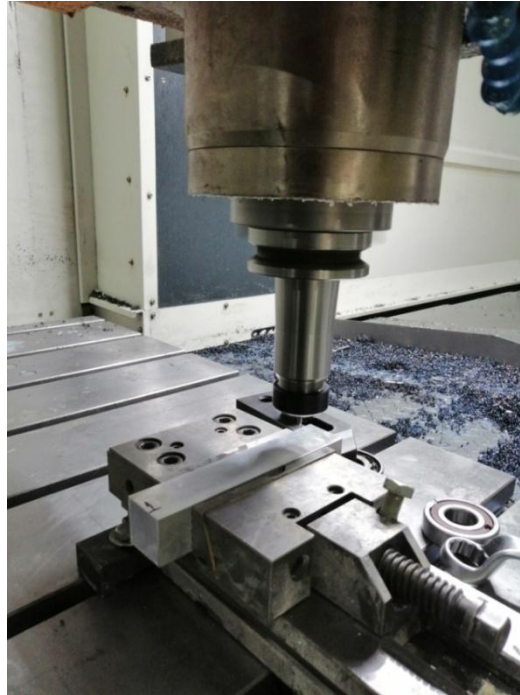
Resim 5.1. Deney numunesinin CNC tezgahına bağlantısı
