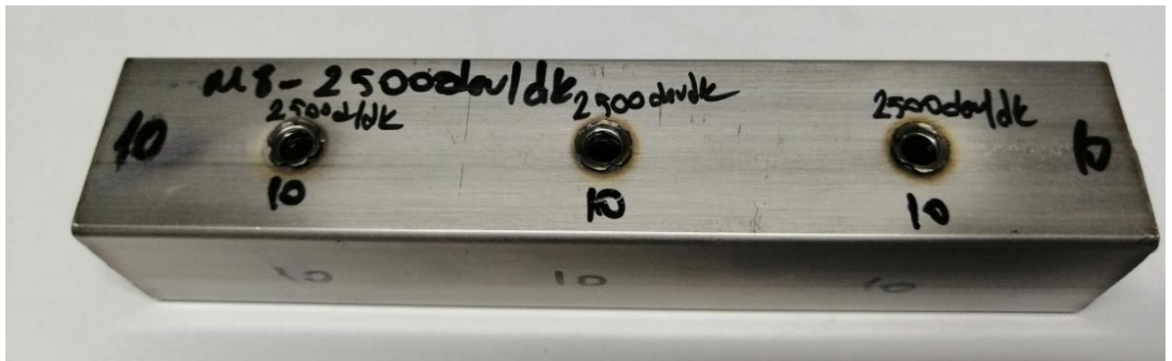
Resim 5.4. Sıvama ucu ile delik delinip kılavuz çekilmiş deney numunesi
