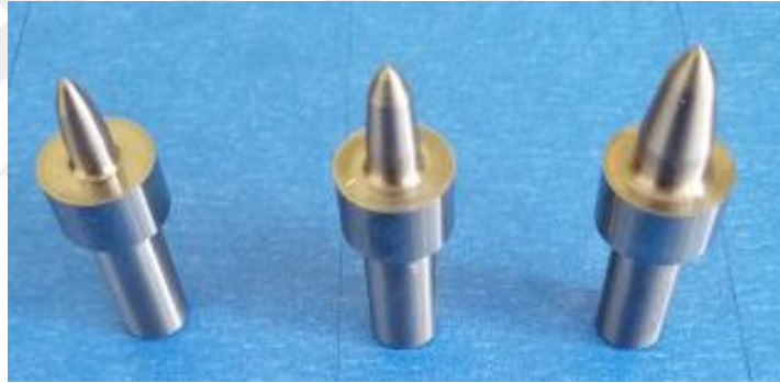
Resim 4.1. Deneyde kullanılan sıvama uçları
