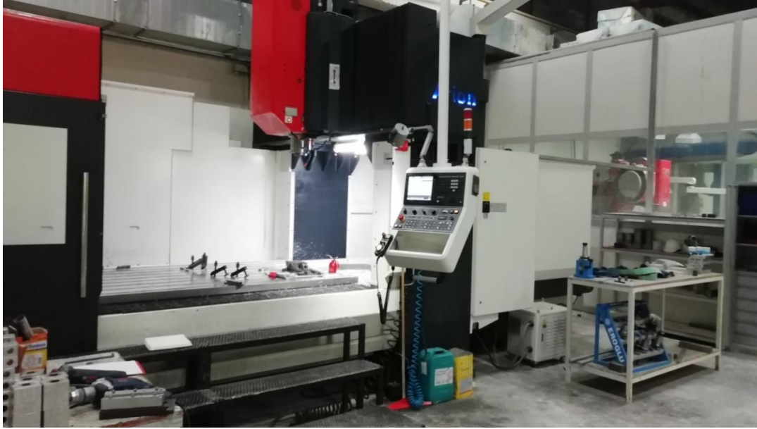
Resim 4.3. CNC köprü tipi dik işleme merkezi
