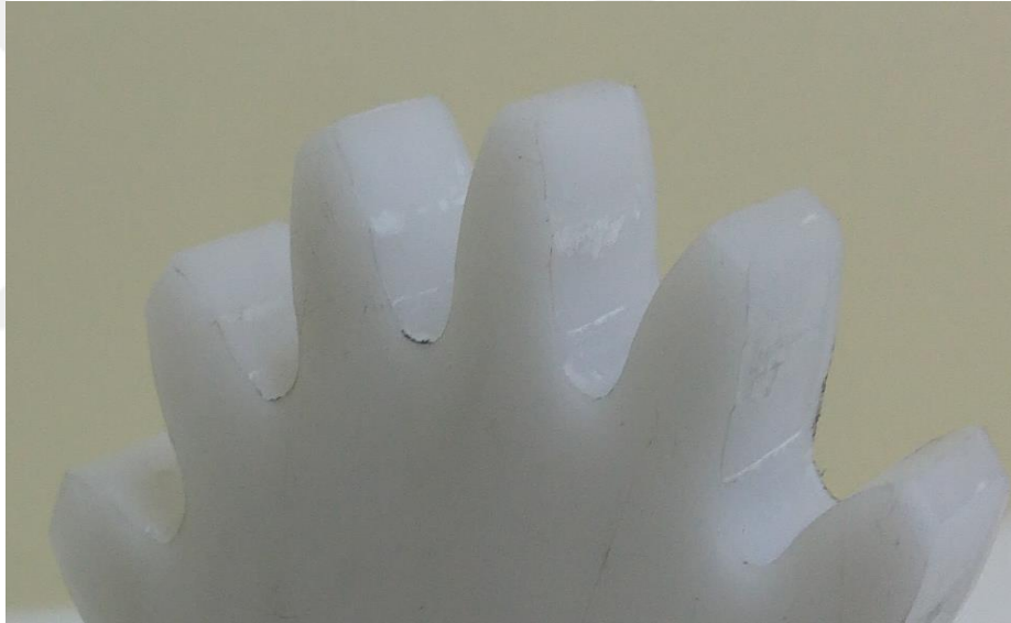
Resim 5.1. Azdırma tezgahında üretilen poliyamid dişlinin deney sonucu aşınması
