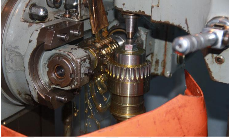
Resim 2.2. Azdırma tezgahında diş açma (Anonim, 2019)
