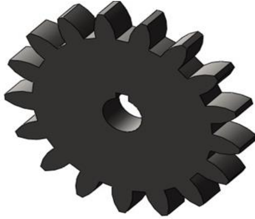
Resim 5.3. Solidworks çizim programında modellenmiş z=17 , m=6 pinyon dişli
