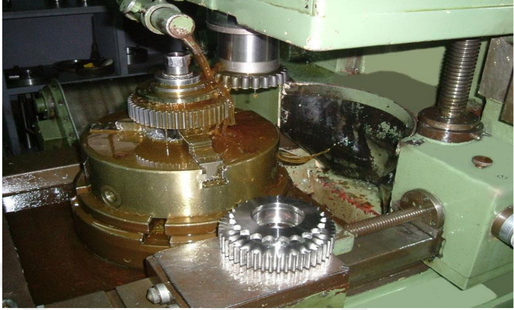
Resim 2.3. Fellow tezgahında dişli açma (Anonim, 2019)
