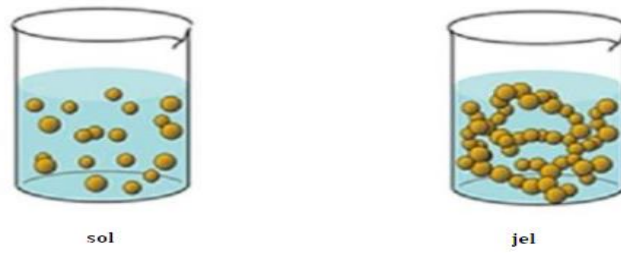
Şekil 2.4. Sol-Jel yapının görünümü
