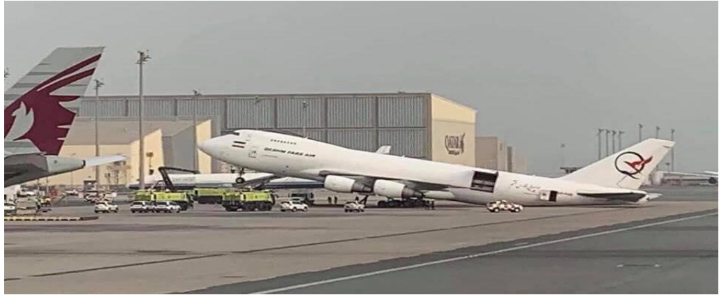
Şekil 2- Yanlış operasyon sonucu uçağın kuyruk tarafının yere vurmaları kaynak: http://www.albiladdailyeng.com/
