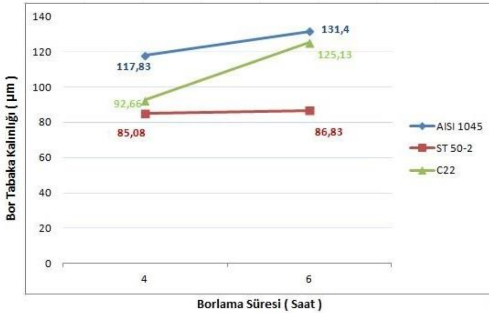
Şekil 4.3. 940°C sıcaklıklarda ve 4 ve 6 saat sürelerde AISI 1045, C-22 ve St 50-2 numunelerinin tabaka kalınlığı ölçümleri
