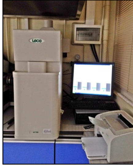
Resim 3.3. LECO AF 700 kül ergime analiz cihazı
