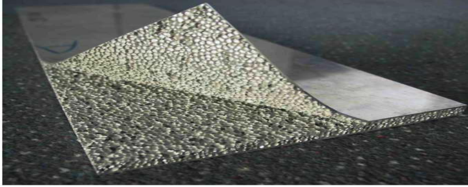
Şekil 2.21. Hafif ağırlıklı alüminyum sandviç panel
