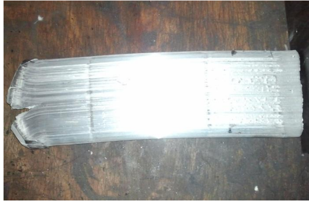
Resim 3.4. Ekstrüzyon sonucu elde edilen numune
