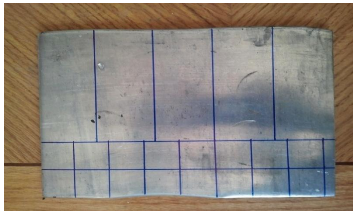
Resim 3.5. Haddeme sonucu elde edilen numune ve markalanması
