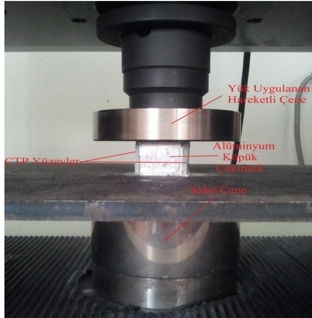
Resim 3.9. Sandviçin kenarı doğrultusunda basma test düzeneği
