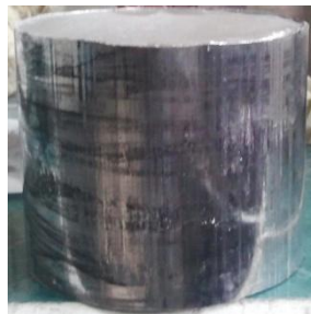
Resim 3.3. Presleme sonucu elde edilen numune
