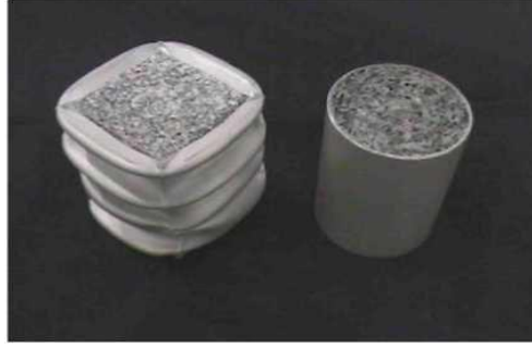
Şekil 2.23. Çarpışma kutusu numuneleri
