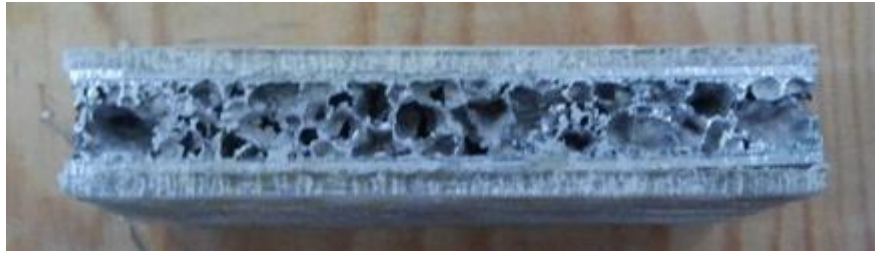
Resim 3.8. Düşük hızlı darbe deneyi için sandviç kompozit test numunesi
