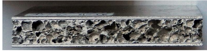
Resim 3.1. Alüminyum köpük sandviç panel
