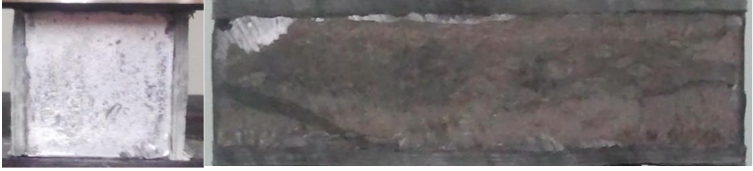
Resim 3.7. Basma ve üç nokta eğilme deneyleri için sandviç kompozit test numuneleri
