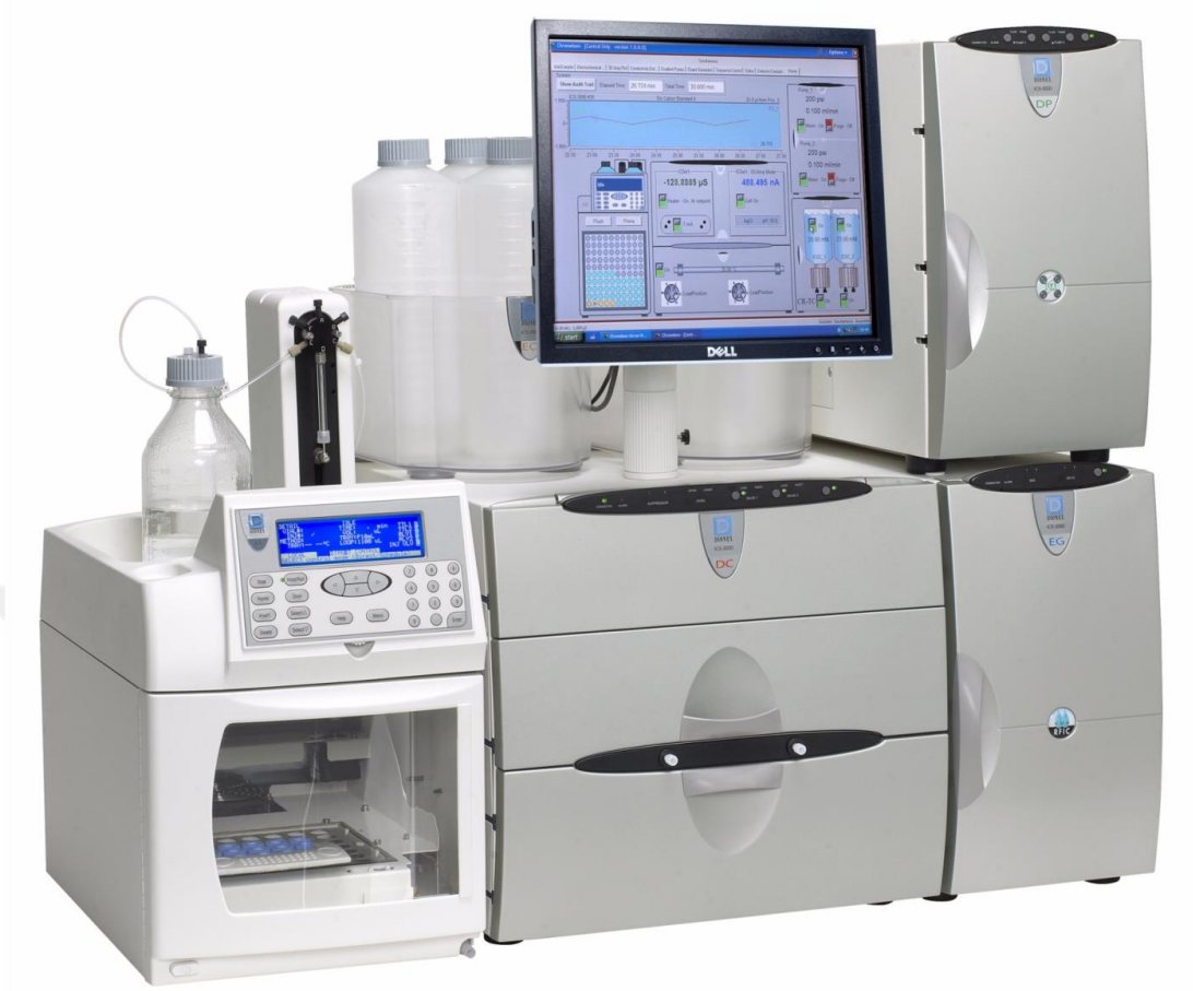
Resim 3.3. Bromat iyonu ölçümü için kullanılan HPLC
