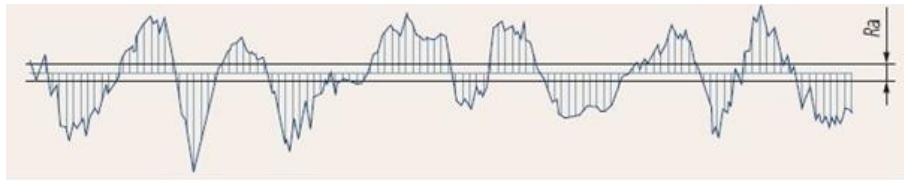
Şekil 3. 1. Yüzey pürüzlülüğünde kullanılan Ra değeri grafiği
