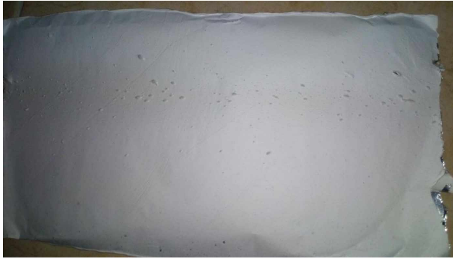
Resim 3.4. Toplayıcı yüzeyinde toplanan spinlenmiş nanofiberler
