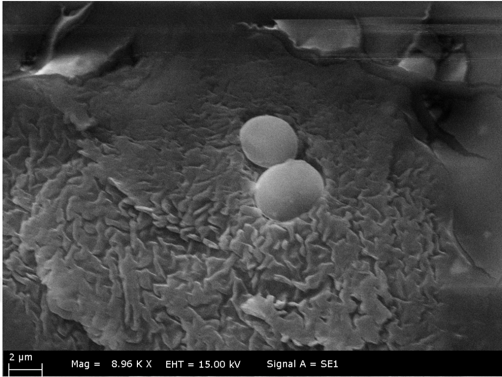
Şekil 4.14. \text{Zn}(\text{NO}_3)_2 \cdot 6\text{H}_2\text{O} tuzundan elde edilen nanopartiküllerin SEM görüntüsü.
