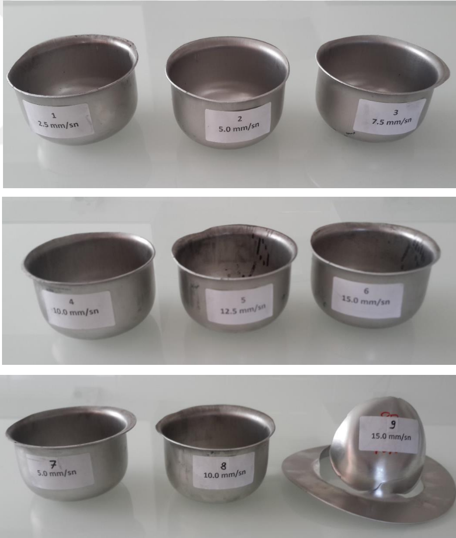
Resim 3.8. Farklı baskı plakası basıncı ve hızlarda çekilen deney parçaları
