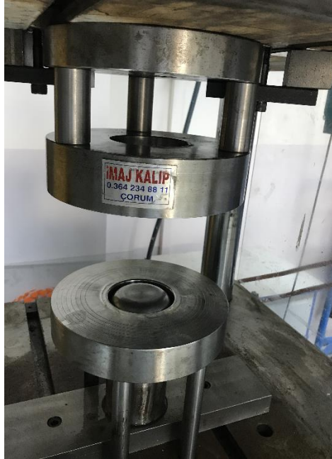
Resim 3.3. Kalıp, zımba ve baskı plakası görünümü
