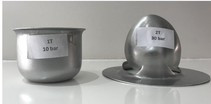
Resim 3.10. 150 mm çapındaki malzemenin farklı baskı plakası basınçlarında çekilen deney parçaları
