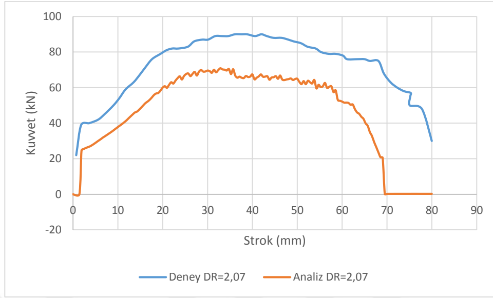
Şekil 4.4. DR=2,07 elde etmek için yapılan için deney ve analiz sonucu elde edilen kuvvet-strok grafikleri
