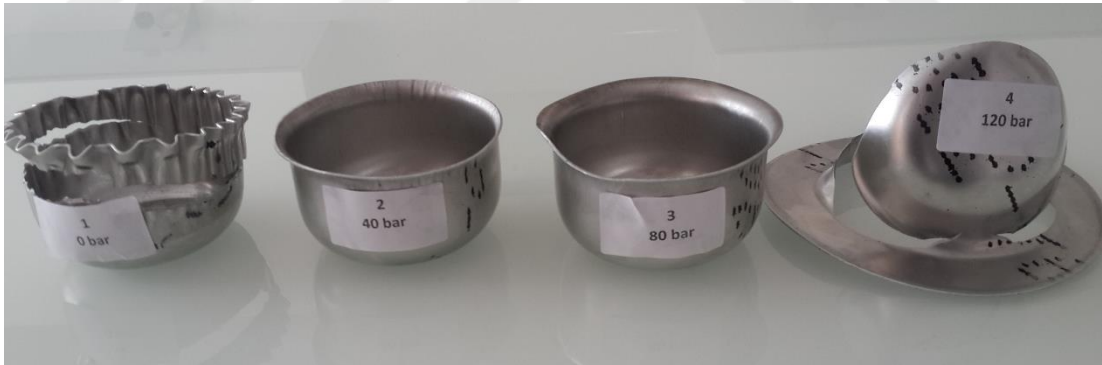
Resim 3.9. 135 mm çapındaki malzemenin farklı baskı plakası basınçlarında çekilen deney parçaları
