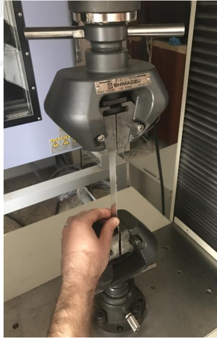
Resim 3.5. Deney parçasının çekme cihazına bağlanması
