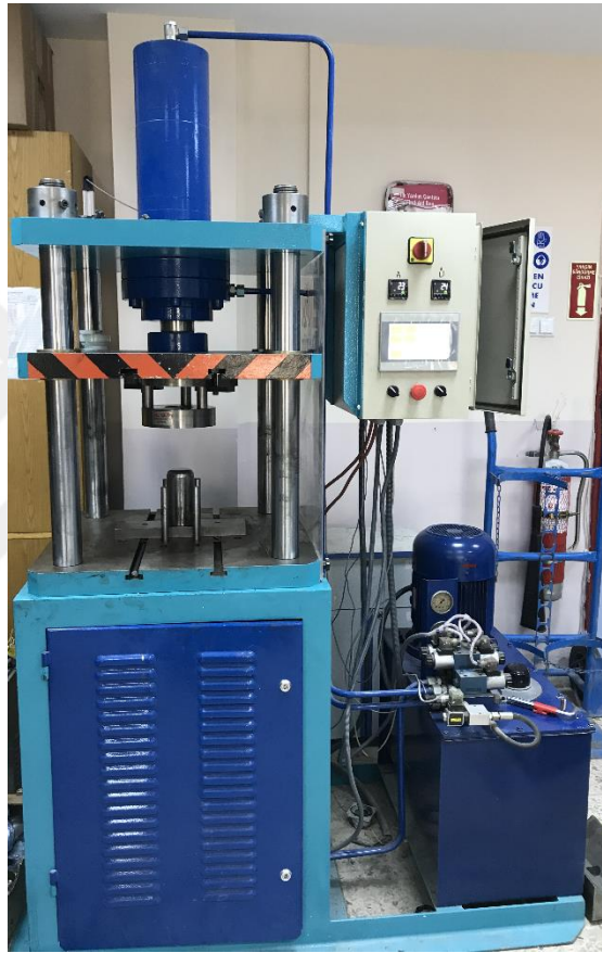
Resim 3.1. Derin çekme deney düzeneği
