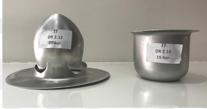
Resim 3.14. DR=2,13 oranı elde etmek için çekilen deney parçaları
