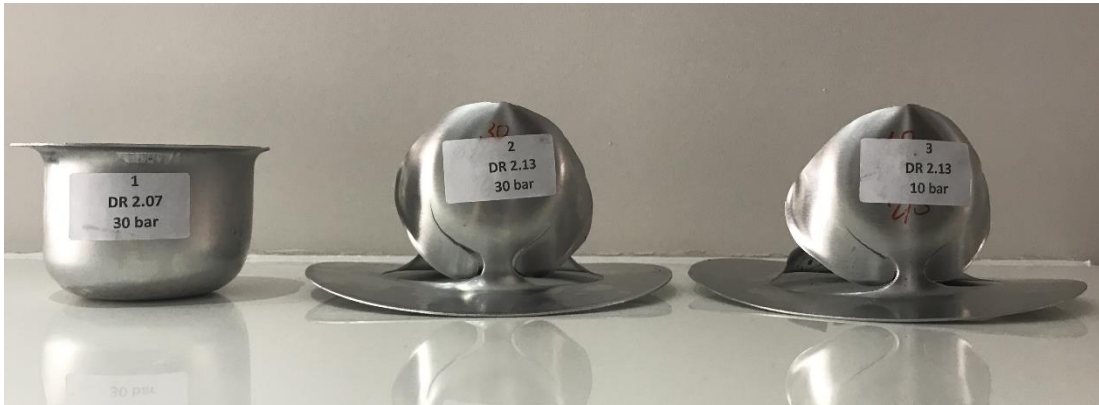
Resim 3.13. Yüksek DR elde etmek için çekilen deney parçaları
