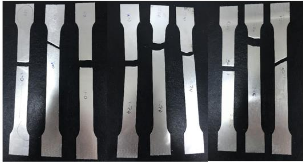
Resim 3.6. Deney numunelerinin koptuktan sonra bir araya getirilmeleri.
