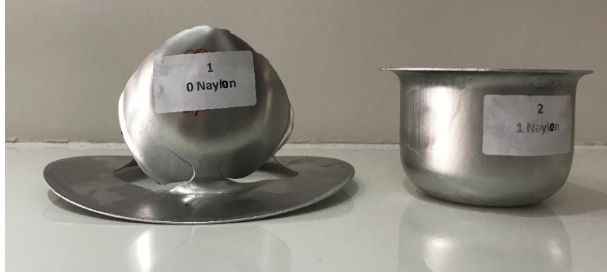
Resim 3.12. 155 mm çapındaki malzemenin farklı sürtünme koşullarında çekilen deney parçaları
