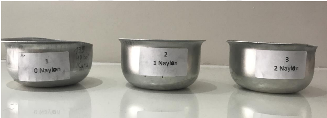
Resim 3.11. 135 mm çapındaki malzemenin farklı sürtünme koşullarında çekilen deney parçaları
