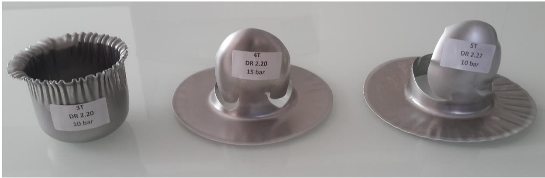
Resim 3.15. DR=2,20 ve 2,27 oranları elde etmek için çekilen deney parçaları
