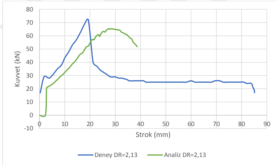
Şekil 4.5. DR=2,13 elde etmek için yapılan için deney ve analiz sonucu elde edilen kuvvet-strok grafikleri
